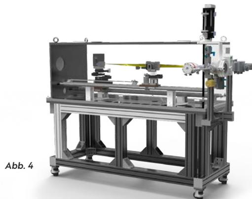
Das Röntgenspektrometer (Abb. 4) bewährt sich in der Praxis. Ein weiteres System für die Anwendung im Vakuum ist in der Planung. Dafür werden eine Optik mit höherer Auflösung entwickelt und die **OWIS Vakuum-Produktserie** für das Hochvakuum mit Drücken bis zu  $10^{-6}$  mbar integriert.
