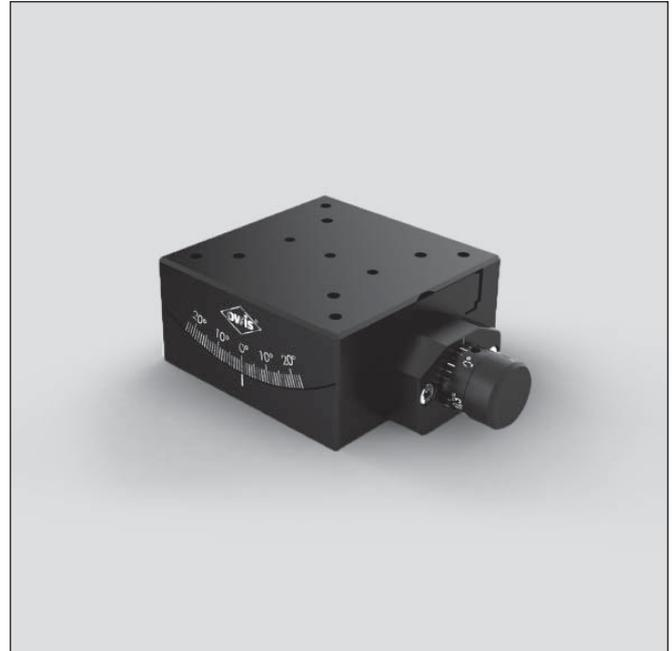
Die Goniometer GO 65L erlauben das Schwenken optischer Elemente wie z. B. Prismen um eine Achse mit definierter Höhe. Der Schwenkbereich beträgt  $\pm 20^\circ$ . Der Abstand von der Montagefläche beträgt 32,5 mm. Durch die reduzierte Bauform wird eine Höhe von ebenfalls 32,5 mm erreicht.
