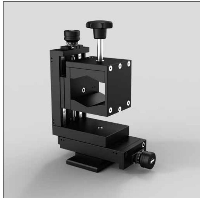
Die Laserjustierungen LJ 80 bestehen aus einer prismatischen Spannaufnahme, die linear in zwei Achsen, quer zur Strahlrichtung ausgerichtet und um zwei Achsen geschwenkt werden kann.
