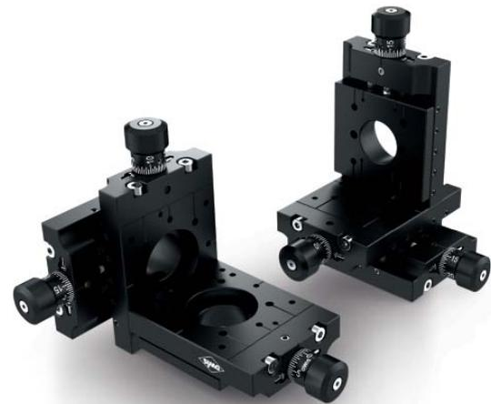
Der VTA 40B-XYZ ist die Kombination aus VTA und KTA 40B mit 6 mm Stellweg je Achse und einer freien Apertur von 11,2 bis 15 mm Durchmesser. Die vorgespannte Feingewindespindel und die präzise justierte Schwalbenschwanzführung ermöglichen ein sehr feinfühliges Positionieren. Durch Klemmung der Feingewindespindeln kann die Position in jeder Achse des VTA 40B fixiert werden.
