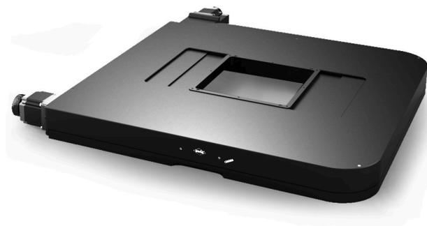
Die Kreuztische der Baureihe CROSS zeichnen sich durch ihre hohe Genauigkeit und eine niedrige Bauhöhe aus. Hauptsächlich für optische Anwendungen haben sie eine quadratische Apertur. Für Anwendungen, bei denen die Apertur nicht benötigt wird, steht eine Einsatzplatte mit Montagebohrungen zur Verfügung. Die weit auseinanderliegenden Führungen lassen ein hohes Kippmoment sowohl in X- als auch in Y-Richtung zu.
