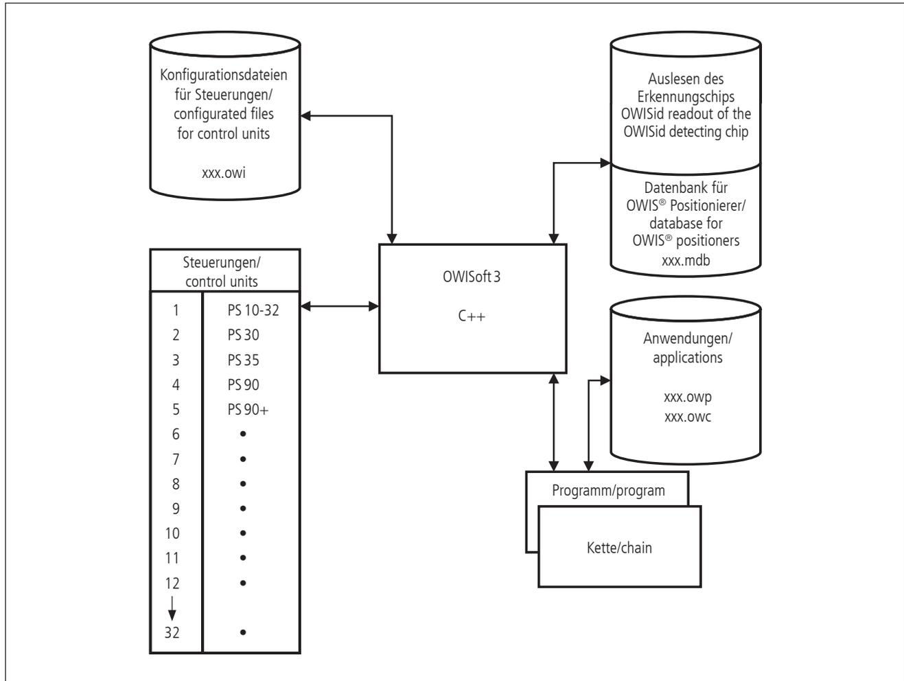
OWISoft 3 verfügt über zwei speicherbare Applikations-Oberflächen. Mit Kette wird in einer Tabelle ein einfacher, sequentieller Bewegungsablauf erstellt. Mit einem Assistenz-Programm können komplexe Bewegungsabläufe mit einer Skriptsprache erstellt, geprüft und ausgeführt werden.
