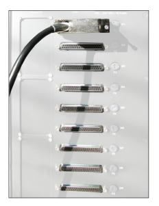
**3)** Die Stromversorgung der Steuerung anschließen.
